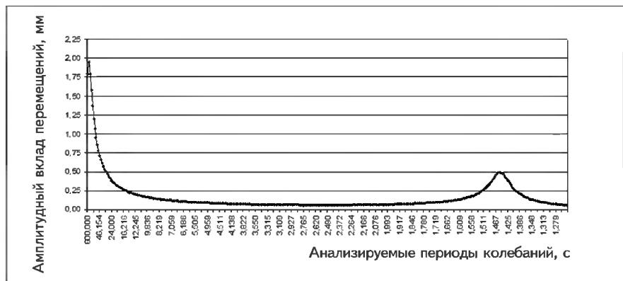
**Рис. 3. Расчетный спектр перемещений башни высотой 70 м в г. Пушкино**
