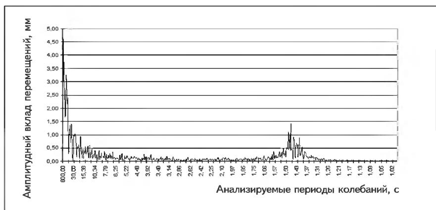
**Рис. 4. Экспериментальный спектр перемещений башни высотой 70 м в г. Пушкино**
