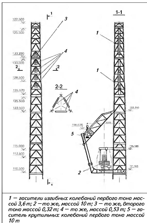
**Рис. 2. Схема установки гасителей колебаний на главном монументе мемориального комплекса Победы на Поклонной горе**
